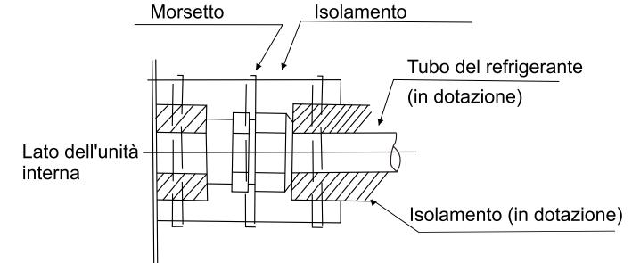
Fig 4.4 Procedura di isolamento dei tubi
