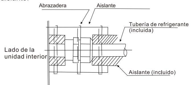
Fig. 4.3 Procedimiento de aislamiento de tuberías
