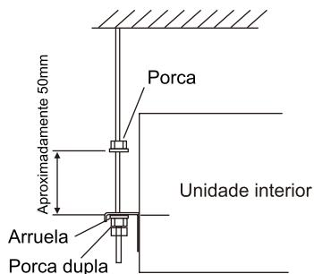
Fig. 3.5 Parafusos e porcas de suspensão
