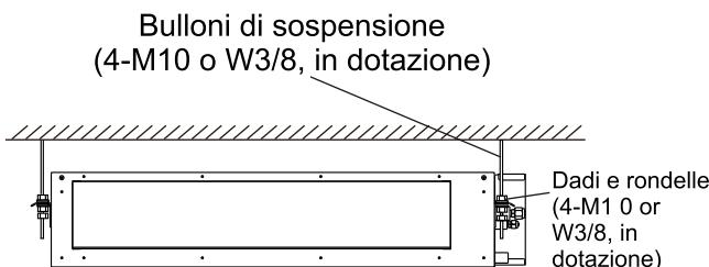
Fig. 3.4 Installazione dell'unità interna
