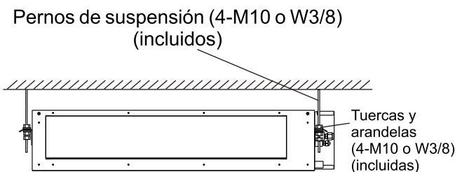
Fig. 3.4 Instalación de la unidad interior
