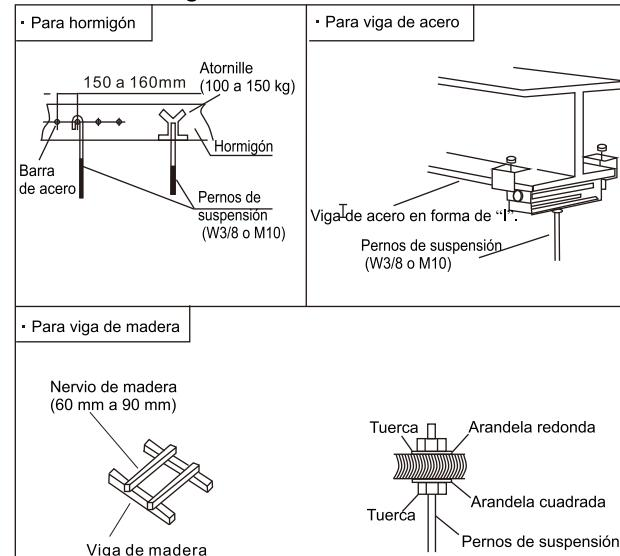
Fig. 3.2.1 Fijar los pernos de suspensión
